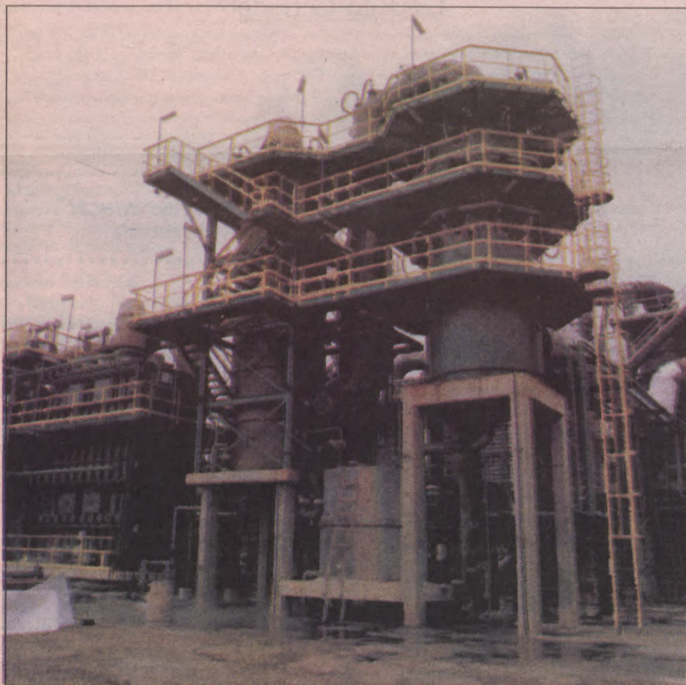
O sistema de Purificação de Gases evitará que o dióxido de enxofre contamine o ar
